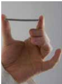
S1 Verformung ≥ 2,5 mm
