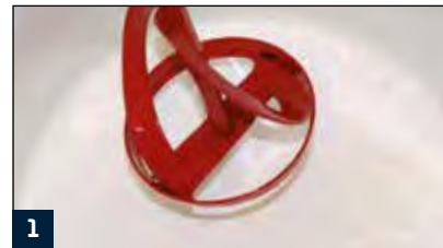
1 Mischen der beiden Komponenten mittels Rührgerät
