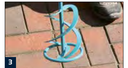
3 Anrühren des Mörtels mittels Korbrührer
