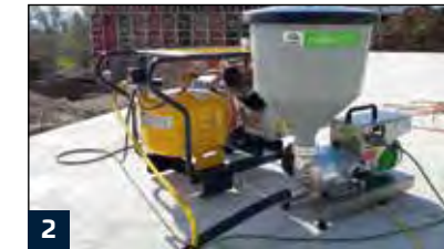
2 Bei maschineller Verarbeitung Spritzmaschine einrichten.
