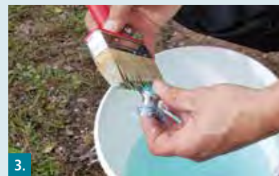
3. Düse + Düsenbohrung für die Luftzufuhr mit geeignetem Werkzeug gründlich reinigen.
