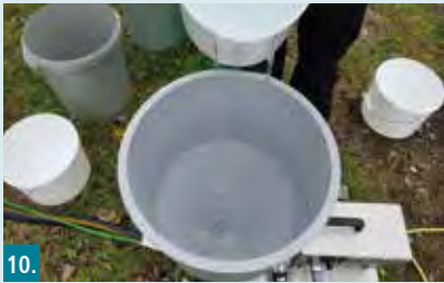
10. Kaltes, sauberes Wasser zum Durchspülen des Mörtelschlauchs einfüllen.
