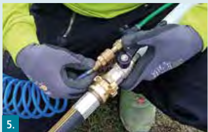
5. Luftschlauch mit Spritzkopf verbinden.
