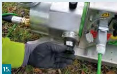
15. Förderleistung der Pumpe auf 0,1 l/min einstellen.
