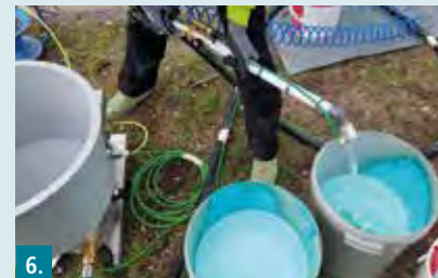
6. Reinigungsvorgang solange wiederholen, bis sauberes Wasser aus dem Spritzkopf kommt.
