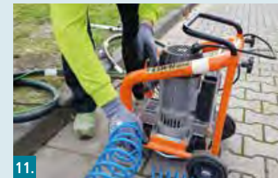
11. Luftschlauch vom Kompressor entfernen.
