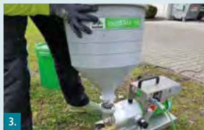
3. Materialbehälter einstecken und Sicherheitsbügel schließen.
