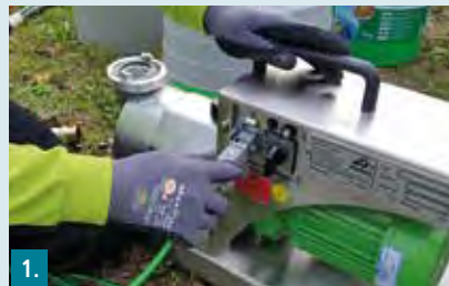
1. Fernbedienung einstecken und Sicherheitsbügel schließen.
