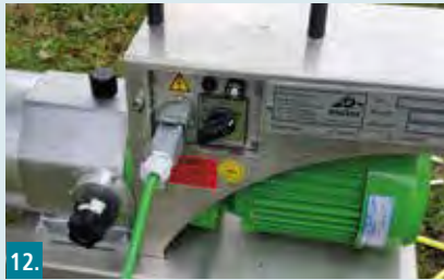
12. Förderpumpe auf vorwärts „FWD“ schalten.
