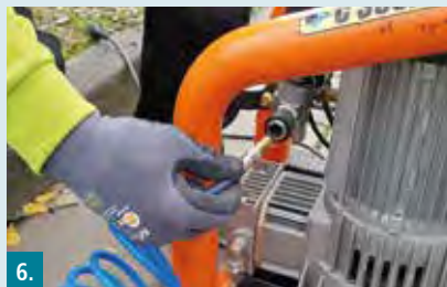
6. Anderes Ende des Luftschlauchs mit Kompressor verbinden.
