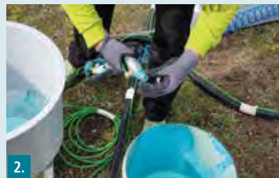
2. Düse vom Spritzkopf entfernen.
