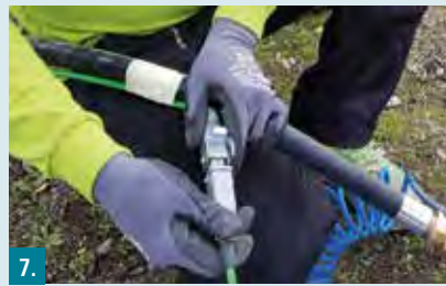
7. Fernbedienung mit Fernbedienungsverlängerungskabel verbinden.
