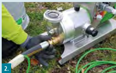
2. Mörtelschlauch anschließen und handfest verschrauben.
